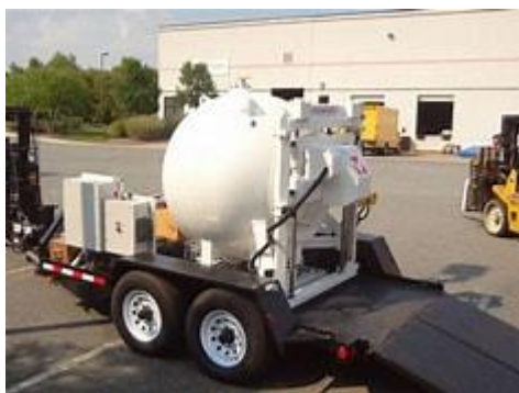
Obr. 13: Transportní kontejner Total Containment Vessel
