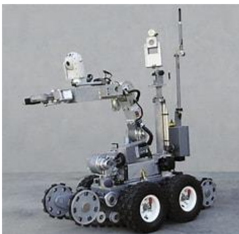
Obr. 10: Pyrotechnický robot Remotec ANDROS F6B
