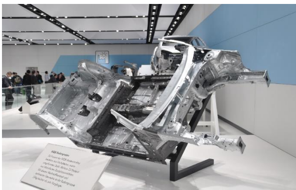
Obrázek 11: Kostra vozidla Škoda Octavia Combi III 81
