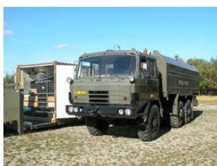
Obr. 27: Úpravna vody UV-2000
