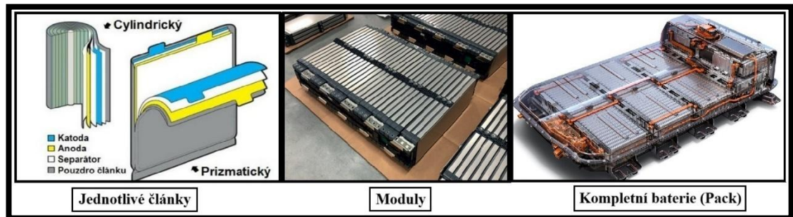
Obrázek 8. Konstrukce baterií. Zdroj: Vlastní zpracování, obrázky z 38 39
