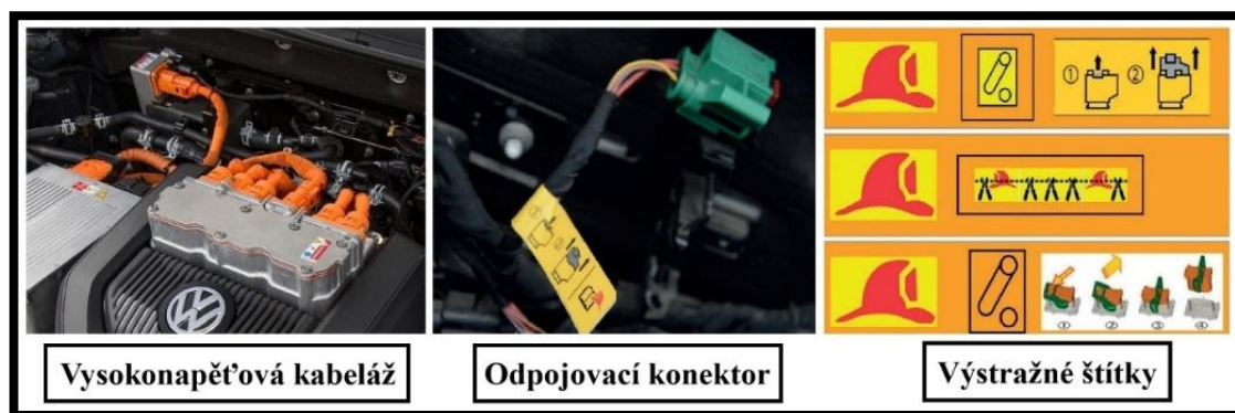
Obrázek 5. Vysokonapěťová kabeláž/ odpojovací konektor/ výstražné štítky. Zdroj: Vlastní zpracování, obrázky z. 28 29
